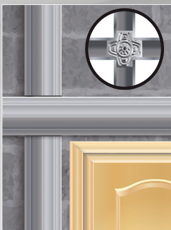
Réaliser le contour d'une porte
